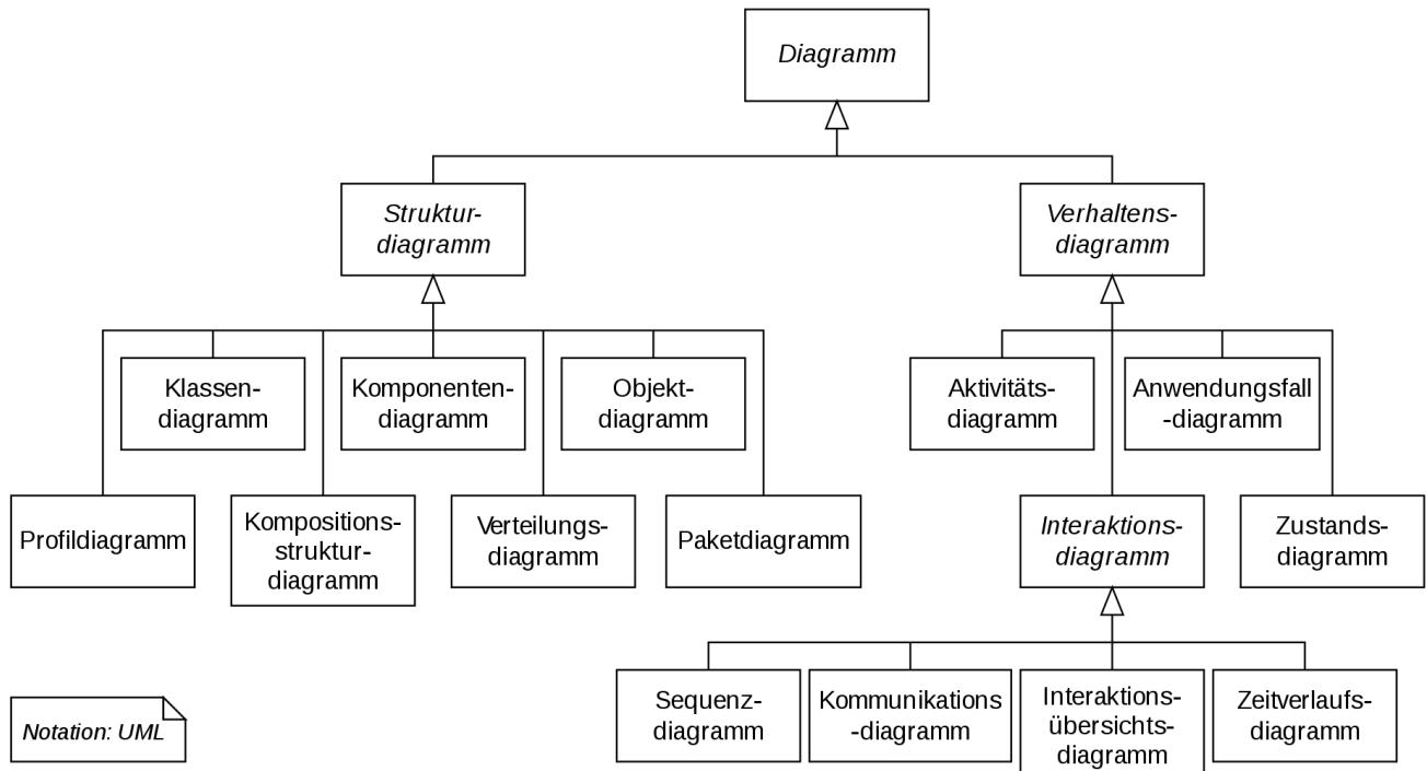
UML Diagramm-Typen [\[WikiUMLDiagrammTypes\]](#)
