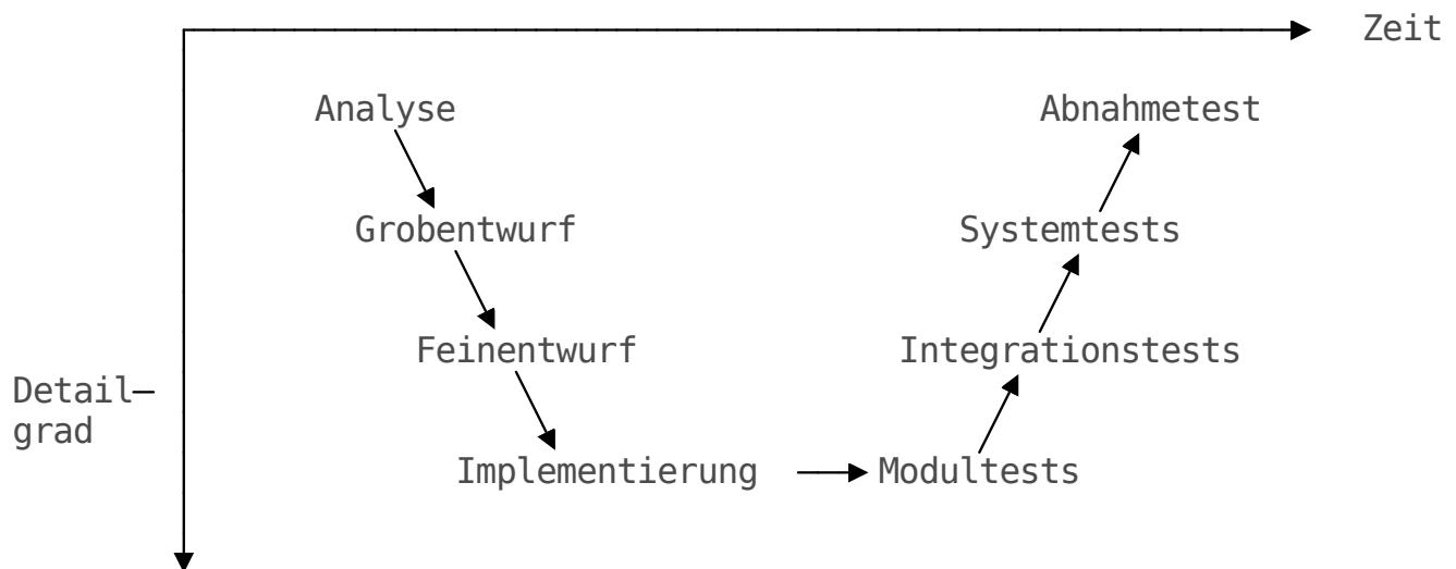
Das V-Modell ist ein Vorgehensmodell, das den Softwareentwicklungsprozess in Phasen organisiert. Zusätzlich zu den Entwicklungsphasen definiert das V-Modell auch die Evaluationsphasen, in welchen den einzelnen Entwicklungsphasen Testphasen gegenübergestellt werden.
