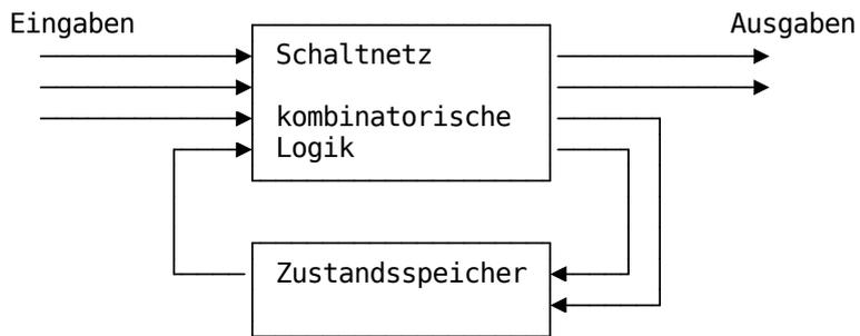
Und wo brauche ich sequentielle Logik? Die Abarbeitung von Befehlen im Rechner basiert darauf. In diesem Fall wird über die Eingabesteuerleitungen ein Befehl codiert und der Zustandsspeicher beinhaltet den erreichten Realisierungsschritt. **Damit wird jeder Rechner zu einem Schaltwerk!**
