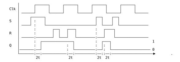
Merke: Durch die Möglichkeit mehrerer Zustandsänderungen in einer Taktphase ist das zustandsgesteuerte RS-Flip-Flop für viele Anwendungen ungeeignet. Welche Idee hat die nachfolgende Schaltung und warum wird sie nicht funktionieren?
