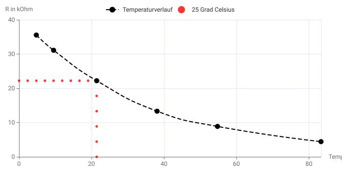
$$egin{split} rac{R_{NTC}}{R_1} &= rac{U_{NTC}}{U_{R1}} = rac{U_{NTC}}{(U_{ges} - U_{NTC})} \ R_{NTC} &= R_1 \cdot rac{U_{NTC}}{(U_{ges} - U_{NTC})} \end{split}$$
