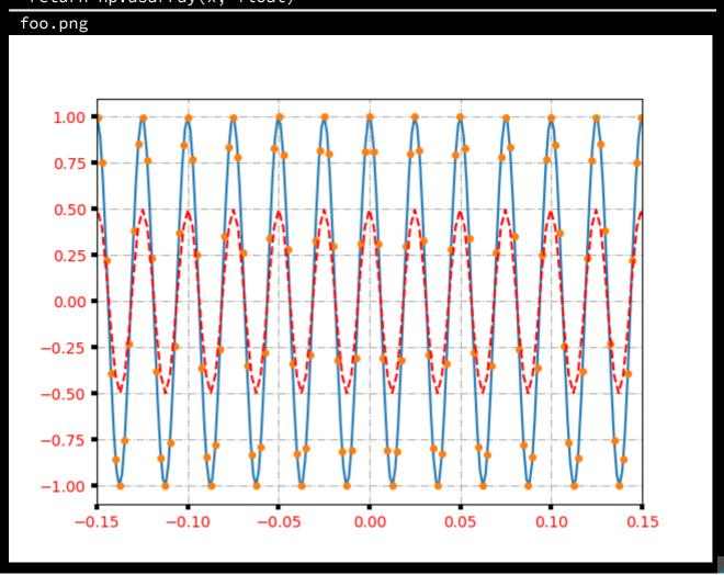
s Wenn ein kontinuierliches Signal, das keine Frequenzkomponenten hat, die über einer Frequenz  $f_c$  liegen mit einer Häufigkeit von größer  $2f_c$  abgetatstet wird, kann das Originalsignal aus den gewonnenen Punkten unverzerrt rekonstruiert werden.
