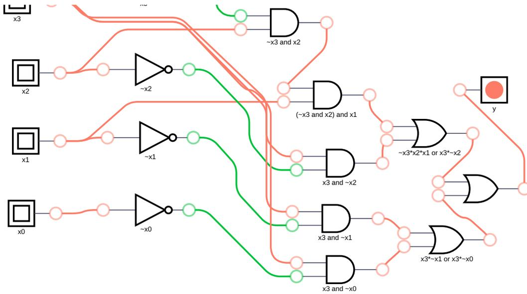
Für die Zustände 6 bis 14 sollte ein Fehler ausgegeben werden
