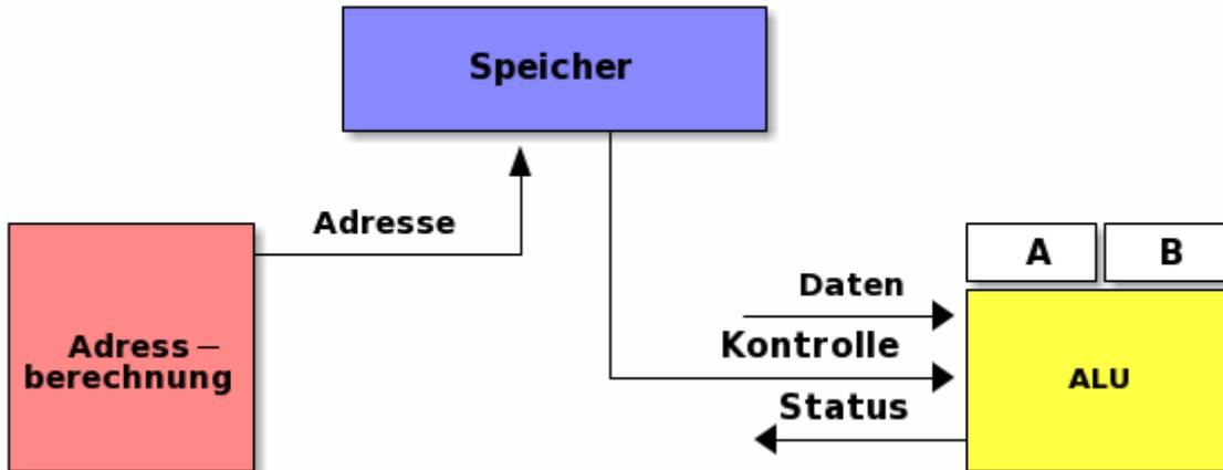
Allerdings bleibt bei dieser Konfiguration unser Status auf der Strecke! Im Grund müssen wir die Information dazu aber Operationsspezifisch auswerten. Es genügt also nicht allein eine Adressberechnung zu realisieren, vielmehr bedarf es einer generellen Steuerungskomponente, die die Ausführung von Befehlen initiiert und überwacht.
