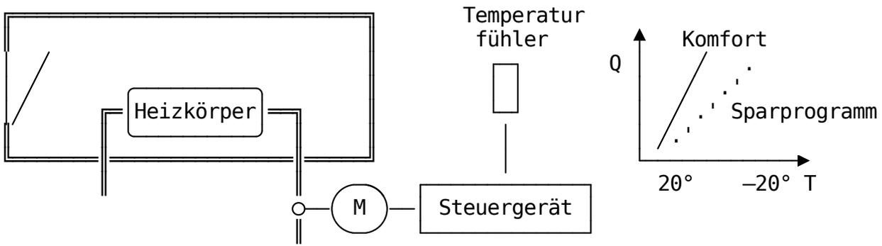
Eine Störung des Systemmodells durch das Öffnen der Tür kann nicht ausgeglichen werden.
