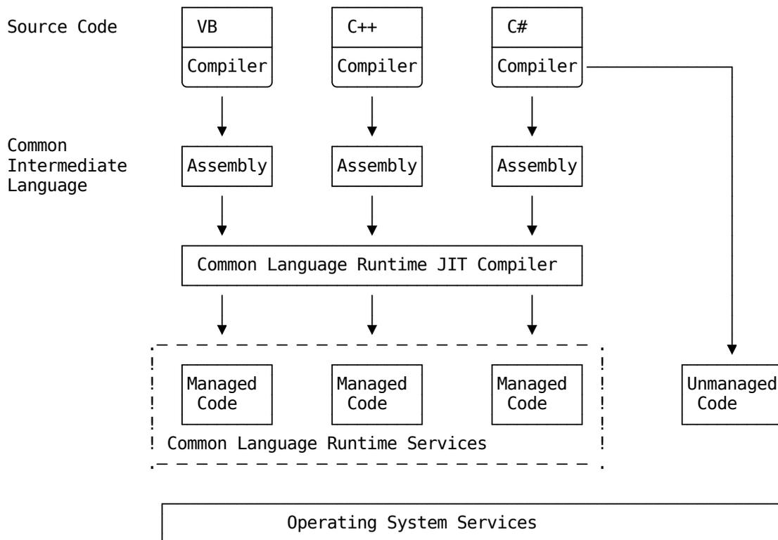
Die spezifischen Compiler der einzelnen .NET Sprachen (C#, Visual Basic, F#) bilden den Quellcode auf einen Zwischencode ab. Die Common Language Infrastructure (CLI) ist eine von ISO und ECMA standardisierte offene Spezifikation (technischer Standard), die ausführbaren Code und eine Laufzeitumgebung beschreibt.
